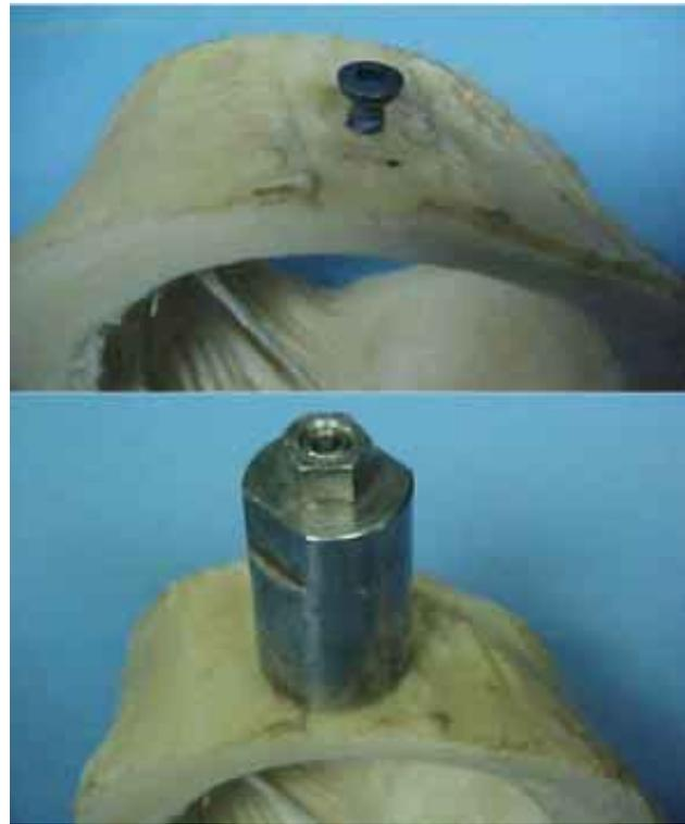
**Figura 5.** Arriba: inserción de un tornillo poliaxial de 3.5 mm de diámetro y 10 mm de longitud en hueso cortical bovino de  $5 \pm 0.3$  mm de espesor. Abajo: retiro del TPA para colocarlo junto con el dispositivo mecánico de extracción axial.
